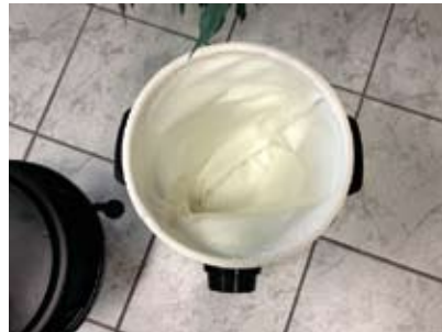
Langzeit Polyesterfilter mit Antihafbeschichtung
